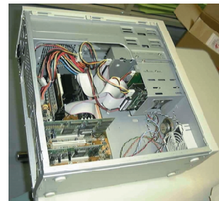
図 1.25: ネットワークとビデオカードを装着した状態
